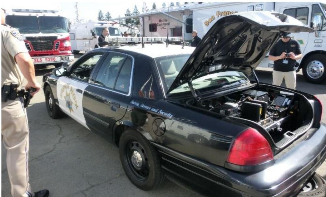
図 1.8 州警察警ら自動車のトランクに積載されている無線通信の増幅設備
