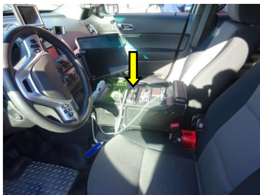
図3 M郡消防指令車に搭載されているCB無線機 註：矢印が当該無線機を示す。
