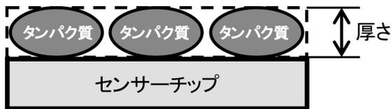
図9 タンパク質の被覆率を計算する際に用いる模式図
