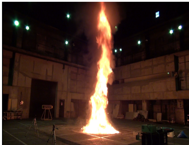
図 6-29 廃食油混合再生資源燃料の危険性評価試験 (消防研究センター・Ecole des Mines d'Ales・千葉科学大学)
