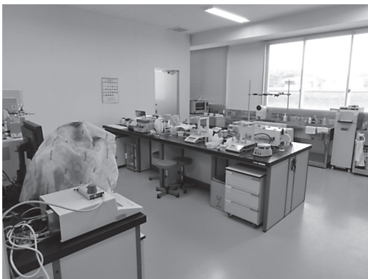
図2. 製剤／化粧品科学研究室の様子。手前に乳化機、偏光顕微鏡、粘度計など、中央に天秤、遠心機、恒温水槽などを設置してある。
